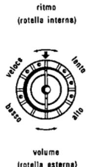
Il volume e il ritmo della soneria elettronica sono regolabili. Le relative rotelle di regolazione si trovano sotto l'apparecchio.
